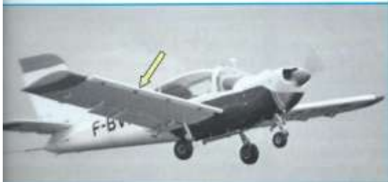
3. Le MS 880 (ici un remorqueur MS 893) et ses bords d'attaque ouverts. Les bords coulisent automatiquement sur leurs guides. Les forces de pression les aspirent en avant, en position 1, à basse vitesse, comme sur la photo pendant un remorqué à 100 km/h. À plus haute vitesse elles les repoussent vers la position 2. Ils sont indépendants des bords de fuite, commandés eux par le pilote.
