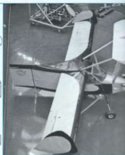
Figure 4. L'élytroplan de Charles de Rougé. La disposition inhabituelle d'une surface stabilisatrice au-dessus et en avant de l'aile produisait une régulation de l'incidence de l'aile susceptible d'empêcher le phénomène de décrochage.
