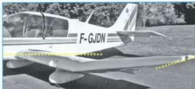
Figure 9. Exemple de vrillage accentué de l'aile sur le Robin DR400.
