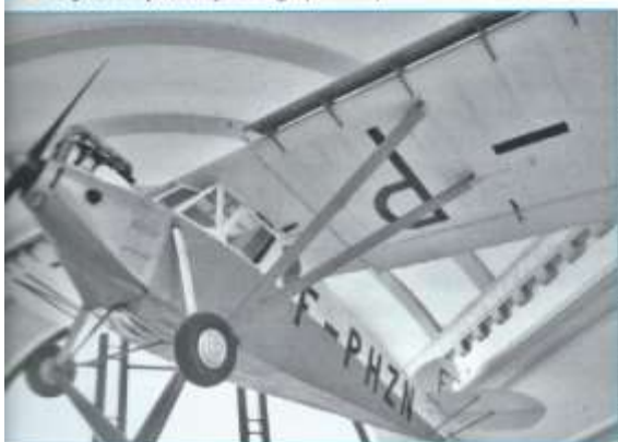
2. Le Potez 36 et ses bords d'attaque. Les bords fixes, en avant de l'attaque de l'aile, permettent de voler à des vitesses minimales de station très basses (50 km/h) ce qui laisse une marge plus importante de vitesse d'approche et la vitesse de décrochage.
