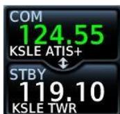
Si une navigation a été programmée et que la fréquence choisie est valide, l'indicatif de la plateforme s'affiche, le type de fréquence (par ex. ATIS). Le « + » signifie que plus d'un type est associé à la fréquence.
