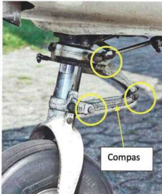
Figure 5. Mécanisme de guidage de la roulette de nez de nombreux appareils à train tricycle : le compas. Ici sur un Cessna 152.
