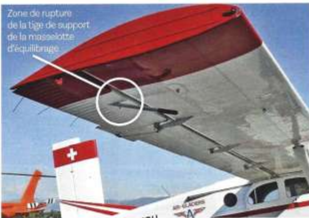
Figure 1. Masselotte d'équilibrage de l'aileron extérieur droit du Pilatus PC6. Ici, appareil identique à l'appareil accidenté. La rupture de la tige de la masselotte d'équilibrage de l'aileron extérieur droit a suffi à produire la probable résonance aéroélastique (flutter) qui a conduit à la rupture des ferrures de fixation de l'aileron et de sa biellette.
