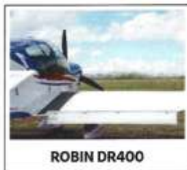
Figure 1. Les quatre types d'avions victimes d'effet de sol ont des ailes basses. Le phénomène bien qu'existant sur des appareils à aile haute est en général moins sensible.
